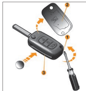
Рис. 52. Замена элемента питания пульта дистанционного управления
